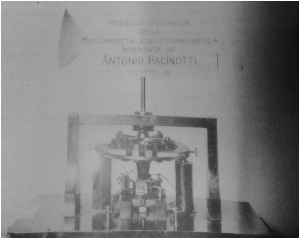
Modello originale della macchinetta elettromagnetica inventata da Antonio Pacinotti
